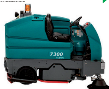
7300 - Batteridrivnen åkbar industri-kombiskurmaskin/skursopmaskin med 102 cm arbetsbredd. Sidosopborste som tillval. Passar för ytor upp till 30000 m 2 .
